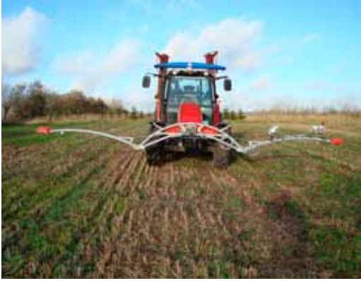
I to marker i Nordjylland er der gennemført forsøg med afprøvning af tre forskellige plantesensorer. Yara N-Sensor er monteret på taget af traktoren. De to Isaria-sensorer er placeret i hver sin side på en bom foran på traktoren. Her er også Greenseeker-sensorerne monteret. (Foto: Jens Lyhne Kristiansen, LandboNord).
